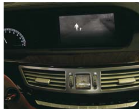
Тепловизионные изображения, генерируемые PathFindIR, могут отображаться на любом мультифункциональном ЖК-дисплее, передающем композитный видеосигнал. В данном случае, ЖК-мониторе, интегрированном в панель управления Mercedes.
